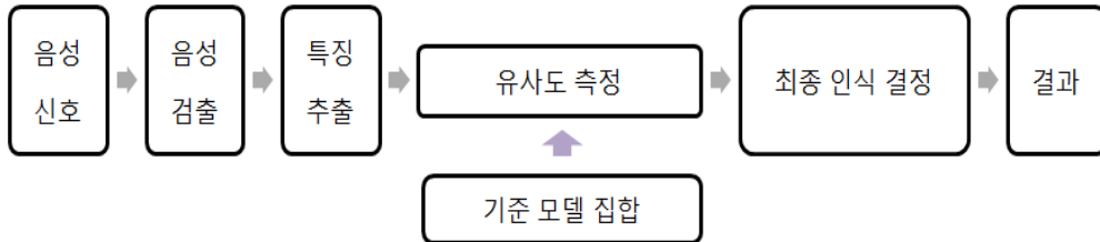
<그림 133> 음성 인식 시스템의 구성 (서상규, 한영균, 2002)
